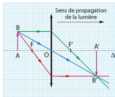
Par construction graphique, on constate que l'image A'B' donnée par la lentille mince convergente est renversée par rapport à l'objet, réelle et plus grande que l'objet.
